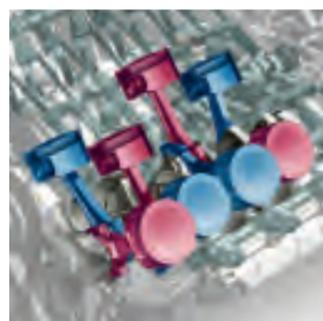
► El motor **6.1 SRT HEMI® V8** con **431 CV** y **569 Nm** del 300C SRT8® proporciona más potencia específica que cualquier otro V8 nunca fabricado en serie por Chrysler. Desarrollado a partir del 5.7, el mayor diámetro de sus cilindros se ve acompañado por una relación de compresión más alta, un nuevo sistema de admisión y escape que mejora el flujo, un mayor régimen de giro y una mayor resistencia estructural acorde con su superior potencia.
